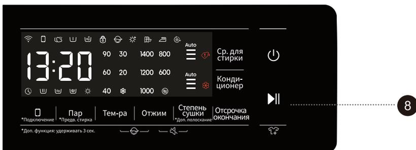
**ВРЕМЯ ДО ЗАВЕРШЕНИЯ ПРОГРАММЫ ИЛИ ОТСРОЧКИ ОКОНЧАНИЯ** (если установлено) отобразится на дисплее.
